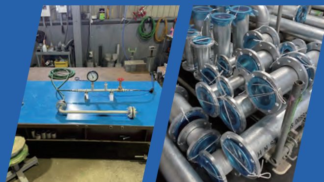
製作工程【気密試験】
